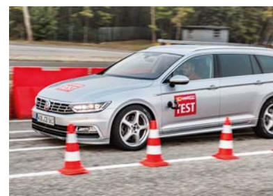
Bremstest auf Trockenheit: Immer wieder wird der Passat aus 100 km/h voll gebremst. Am besten verzögert der Pirelli P Zero.
