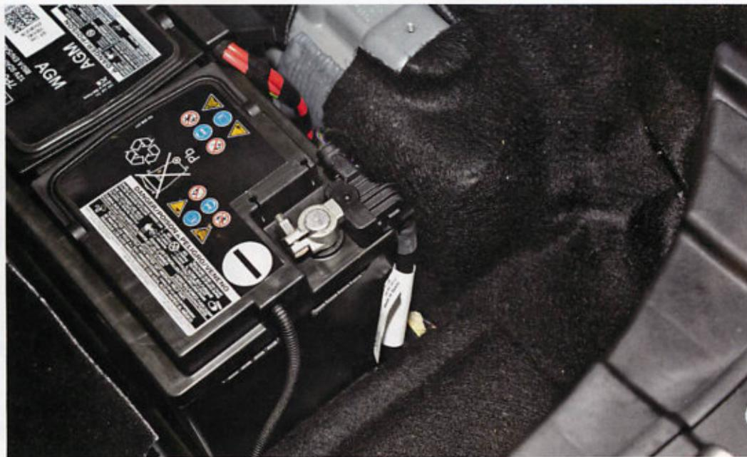
**Bild 6** Wartungsfreie Batterien haben ein komplett verschlossenes Gehäuse. Bei diesem Konzept reicht der Elektrolytvorrat für die gesamte Lebensdauer der Batterie
