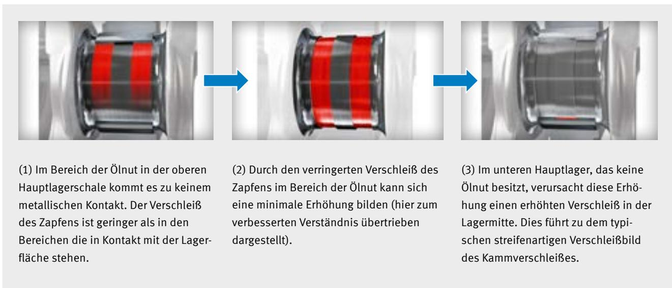
Abb. 2: Ungünstige Materialpaarungen von Lager und Zapfen
