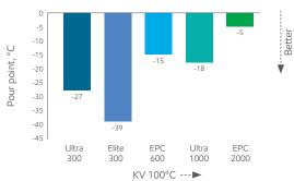
SpectraSyn Elite 300 provides lower pour point.
