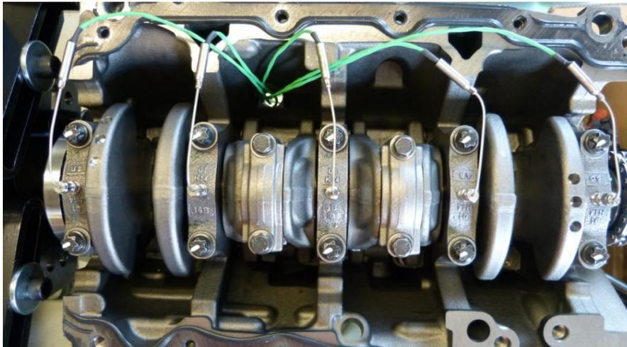
**Abbildung 2.** Temperatursensoren messen die Temperatur jedes Hauptlagers.
