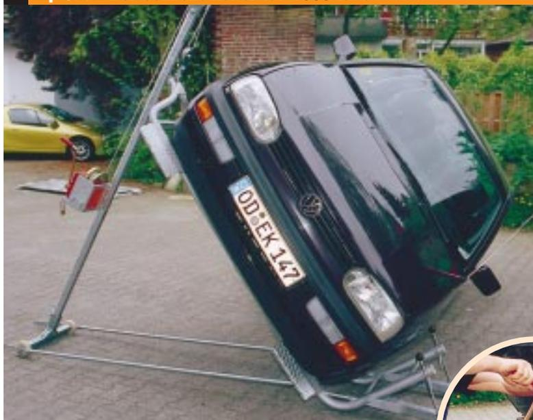
Mit einer Seilwinde (rechts) wird das Auto langsam auf die Seite gekippt
