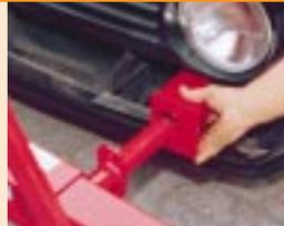
**Der Carlifter greift in die Längsträger. Die Stoßstangen müssen abgebaut sein**
