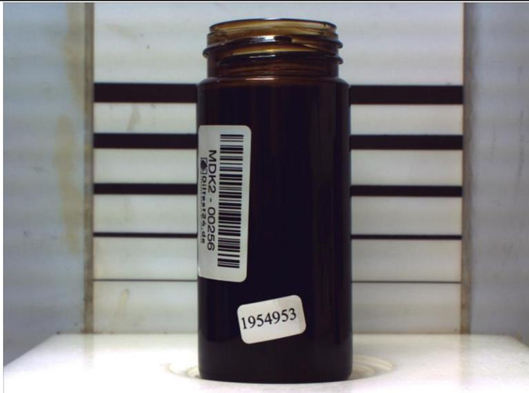
Die Probe ist dunkel, fast schwarz und undurchsichtig. Bei Dieselmotoren sorgt der eingetragene Ruß sehr schnell für diesen Effekt und ist daher kein Bewertungskriterium. Es können keine festen oder flüssigen Verunreinigungen erkannt werden.
