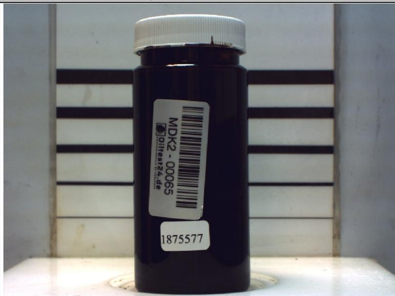
Die Probe ist sehr dunkel, fast schwarz und undurchsichtig. Bei direkteinspritzenden Ottomotoren sorgt der eingetragene Ruß sehr schnell für diesen Effekt und ist daher kein Bewertungskriterium. Es können keine festen oder flüssigen Verunreinigungen erkannt werden.
