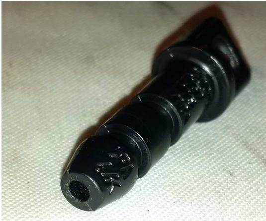
**Zusätzlich habe ich das Stangerl mit Kraftkleber eingeklebt, vorher mit einem Klebeband das genaue Maß markiert, wo dieser anfängt. Dabei das obere Bild beachten damit die Maße auch passen (Anschlagfläche Stoppel).**
