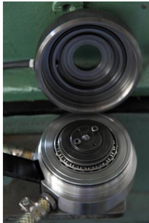
Foto 2: Kegelrollenlager
