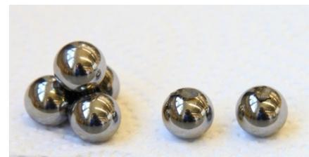
Foto 5: Verschweißte Testkugeln
