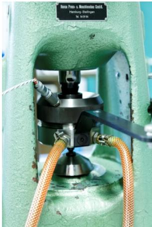
Foto 1: Vierkugel-Apparat als Antriebsgerät für KLR-Test
