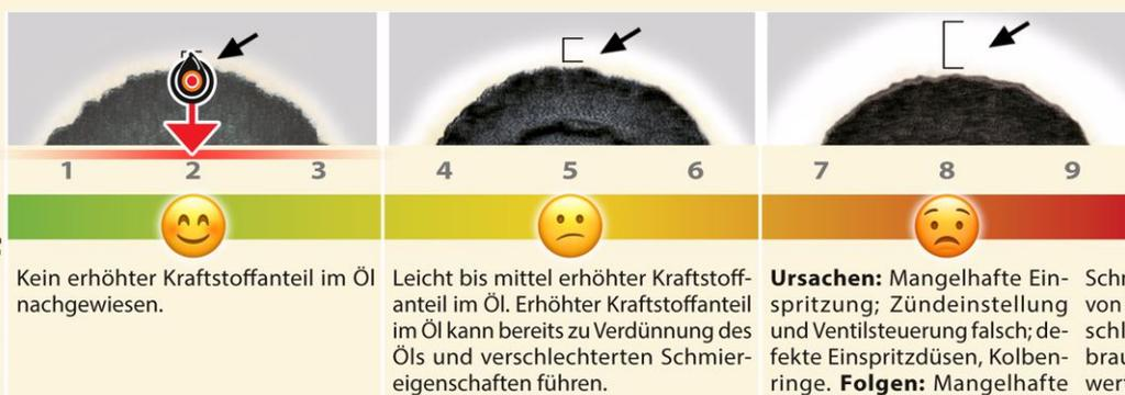
Es gelangt unverbrannter Kraftstoff an den Kolben vorbei ins Motoröl.
