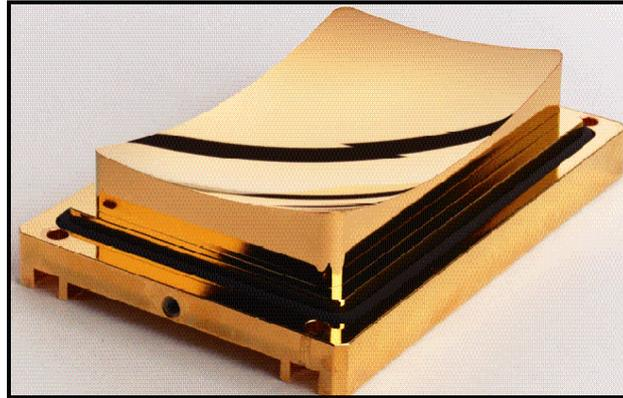
Figur 23 Goldbeschichteter Spiegel der Gasmesszelle
