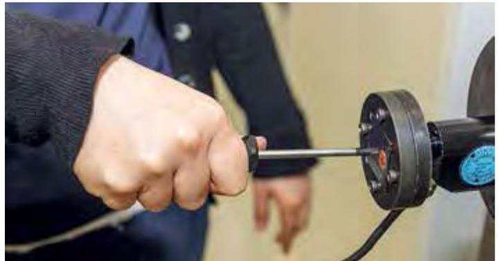
**HANDARBEIT:** An einer Messdose haben wir mit mehreren Anwendern ermittelt, wie stark man wirklich an der Schraube drehen kann.
