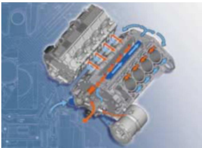
Bild 8: Motorinterner Kühlkreislauf
