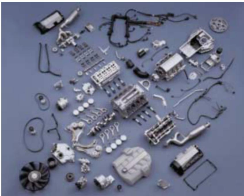
Bild 15: Motorbauteile „Explosionsanordnung“
