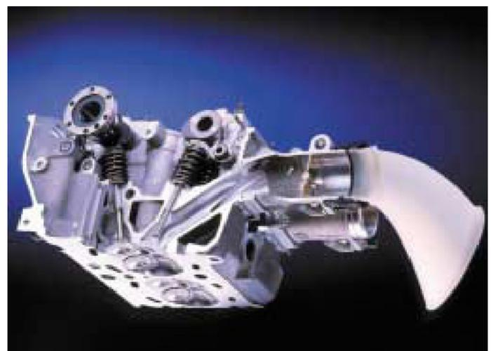
fahren (MIM = Metall Injection Moulding) hergestellt. Dadurch kann ein Bauteil vier Teile und die entsprechenden Füge- und Montagevorgänge ersetzen. Mit der steifen, spielfreien Gasbetätigung, dem geringen Volumen zwischen Drosselklappe und Einlassventil und einem EDR-Steller mit großer Verstellgeschwindigkeit (105 ms Verstellzeit zwischen Leerlauf- und Vollast-Position) wurden die konstruktiven Grundlagen für das direkte, BMW M-typische Ansprechverhalten des Motors geschaffen.
