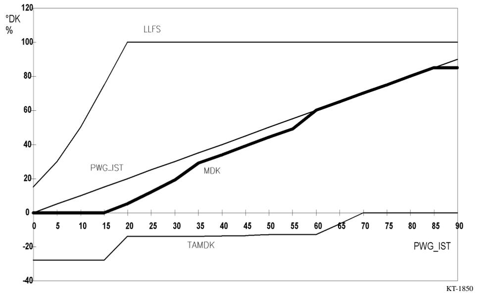
Abb. 22: Füllungsvorsteuerung über MDK und Turbulenzsteller ZWD
