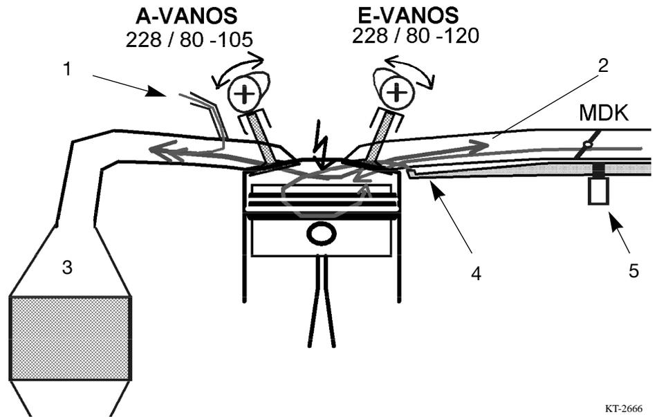
Abb. 13: Prinzipdarstellung der Anbaukomponenten
