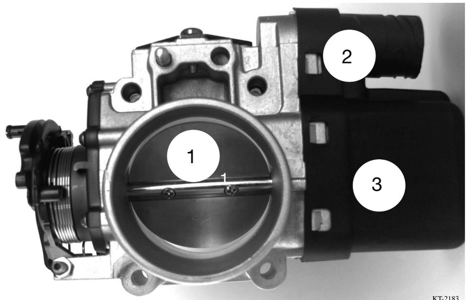
Abb. 20: Motor Drosselklappe
