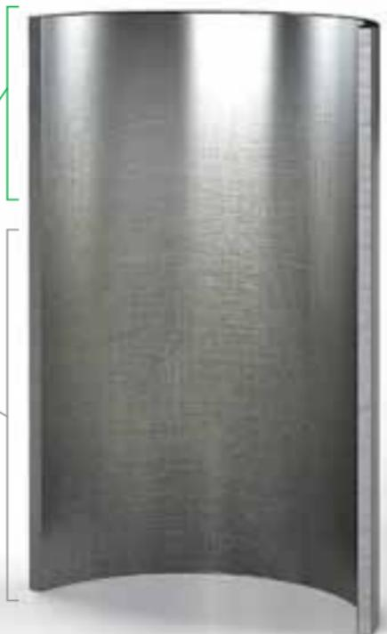
Der Revitalisant modifiziert die Honung im Bereich der intensivsten Anpassung (Zylinder-Kolben-Gruppe in der Nähe des oberen Totpunktes) und lässt sie in den unbelasteten Bereichen unverändert.
