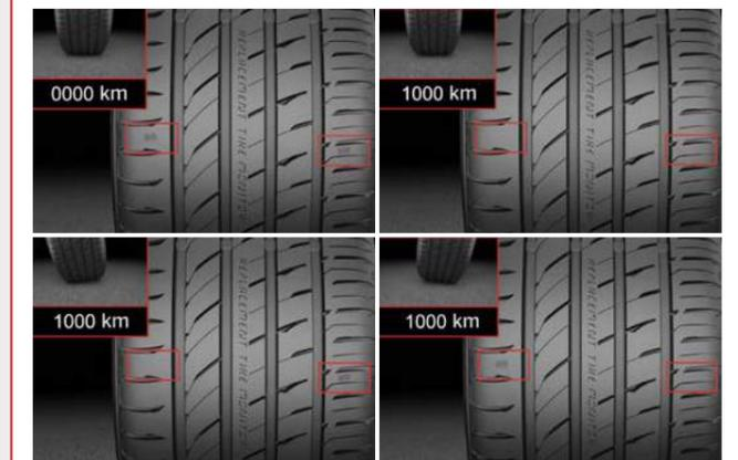
Der **VAI (Visual Alignment Indicator)** hebt ungleichmäßigen Abrieb hervor und zeigt dem Fahrer an, ob das Profil einseitig abgenutzt wird. Das hilft, den Verschleiß der Reifen zu reduzieren.
