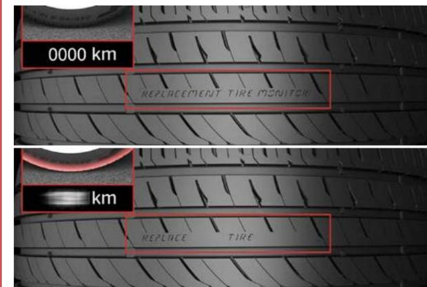
Der **RTM (Replacement Tire Monitor)** zeigt dem Fahrer frühzeitig an, wann ein Reifenwechsel notwendig ist. Das erhöht die Fahrsicherheit entscheidend.
